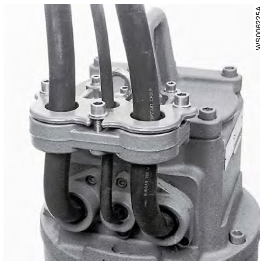
Рис. 18: Держатель кабеля. В насосах с MAS 801 нет вспомогательного кабеля.
